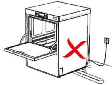
Achten Sie beim Aufstellen Ihrer Spülmaschine darauf, dass der Wasserzulauf, die Chemikalienschläuche und die Ablaufschläuche nicht geknickt oder gequetscht werden. Es muss außerdem darauf geachtet werden, dass die Spülmaschine nicht auf einem ihrer Zulaufschläuche/Leitungen steht.
